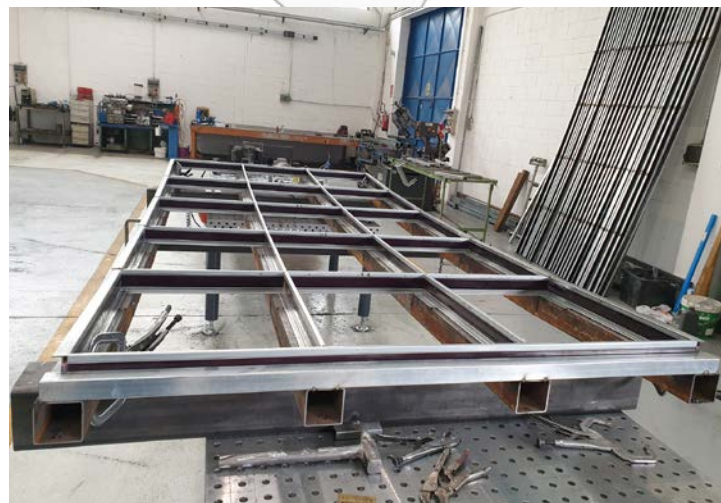
Per l'involucro edilizio, CBC è in grado di realizzare anche telai per facciate continue.
