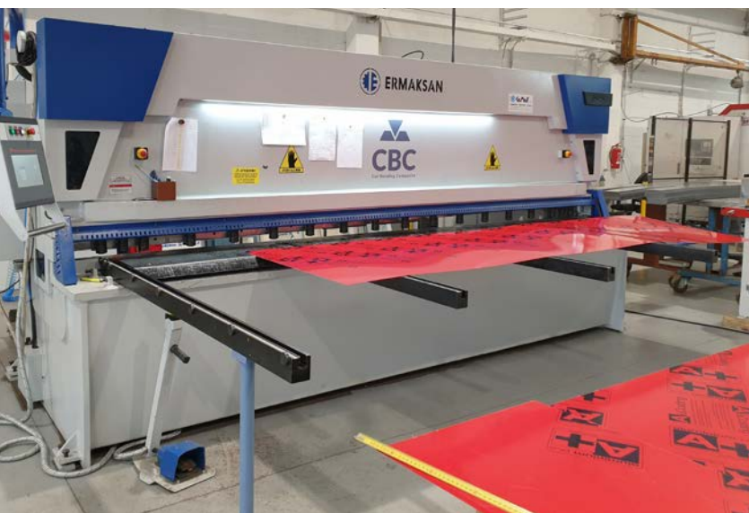
Vista della cesoia idraulica a ghigliottina a Cnc, ad angolo variabile, Ermaksan, modello HVR 4100x6.
