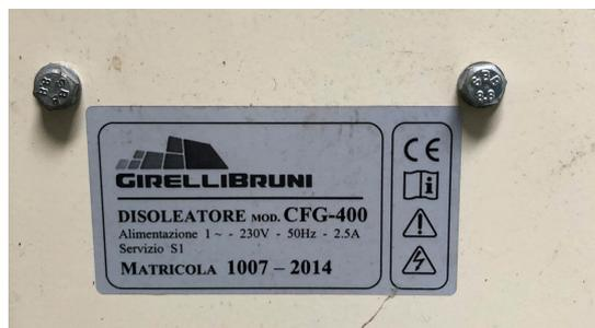
**DISOLEATORE NUOVO GIRELLI-BRUNI, MOD. CFG-400, ALIMENTAZIONE 1, 230 V, 50 HZ, 2.5A, SERVIZIO S1, SN 1007-2014**
