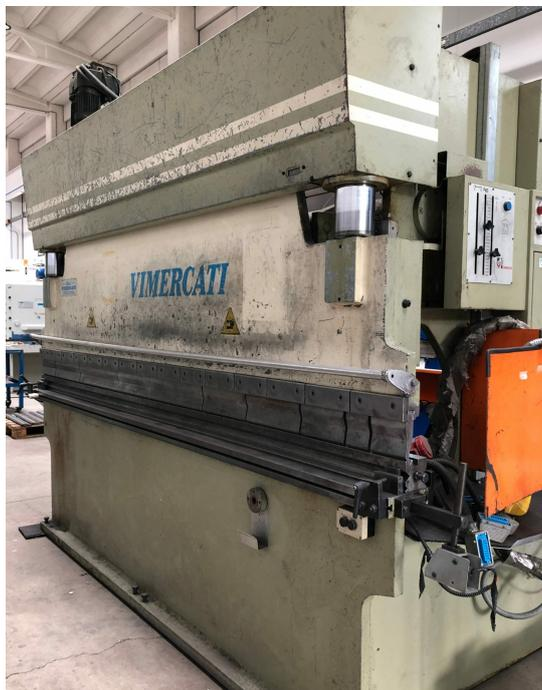
PRESSA PIEGATRICE IDRAULICA "VIMERCATI" USATA A BARRA DI TORSIONE 3000x40TON, LUNGHEZZA DI PIEGA 3000 MM , POTENZA 40 TON, 3 ASSI , CONTROLLO NUMERICO "MECOS", ANNO DI PRODUZIONE 1992, MATRICOLA 1430
