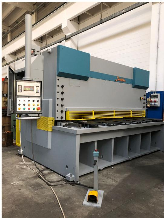
**CESOIA A GHIGLIOTTINA IDRAULICA "BAYKAL" MOD. HNC 3100X20 USATA**, LUNGHEZZA UTILE DI TAGLIO 3100mm, CAPACITA' DI TAGLIO MAX 20mm, INCAVO 500mm, REGISTRO POSTERIORE MOTORIZZATO CON POSIZIONATORE PRG 911, REGOLAZIONE ANGOLO DI TAGLIO, REGOLAZIONE INTERSPAZIO LAME, ANNO 2003, S.N. 6476, CE, PESO 22.000KG
