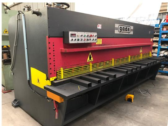
CESOIA A GHIGLIOTTINA IDRAULICA "GADE" USATA, MOD. 40/04, LUNGHEZZA DI TAGLIO 4050mm, CAPACITA' DI TAGLIO 6mm FE 4mm INOX, INCAVO 510 mm, PESO 9700 KG, ANNO 1997, LAME VERIFICATE
