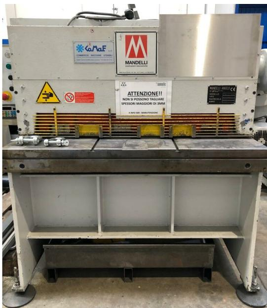
**CESOIA MECCANICA "MANDELLI" MOD. CM 1003 USATA**, LUNGHEZZA DI TAGLIO 1000mm, SPESSORE DI TAGLIO MAX 3mm, REGISTRO MOTORIZZATO CON POSIZIONATORE HT071, ANNO 2005, S.N. 029, CE
