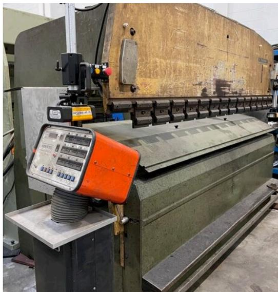
PRESSA PIEGATRICE "SCHIAVI" 75/30 USATA , MOD. RG 75/30, LUNGHEZZA DI PIEGA 3000mm, POTENZA 75TON, INCAVO 400mm, REGISTRO MOTORIZZATO, FOTOCELLULE DSP NUOVA ELETTRONICA, PULPITO DI COMANDO
