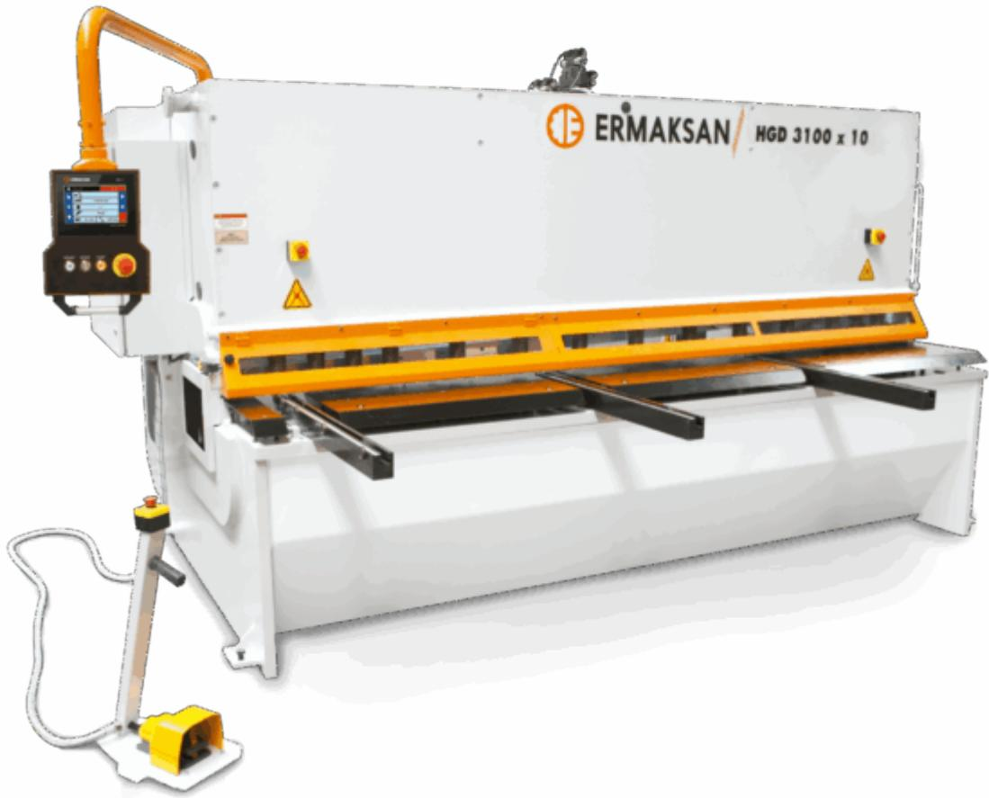
• **CESOIA IDRAULICA A LAMA OSCILLANTE MOD.HGD**
