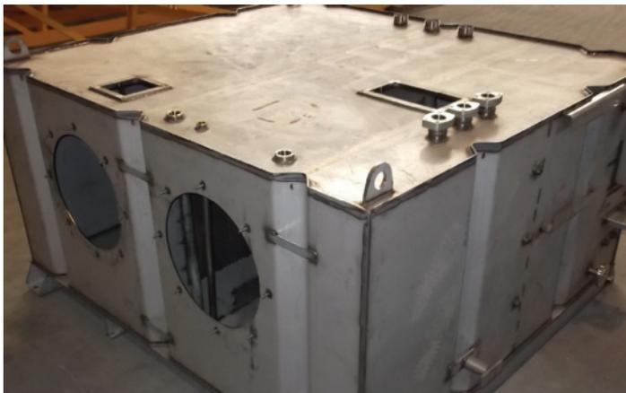
Centralina oleodinamica adibita a impianti petroliferi realizzata da C.o.m.s. in acciaio Aisi 316 L.
