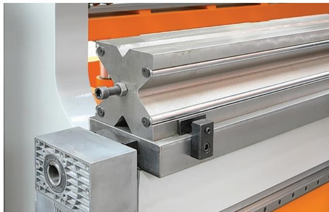
Dettaglio tavola di centinatura meccanica motorizzata automatica, controllata dal Cnc.
