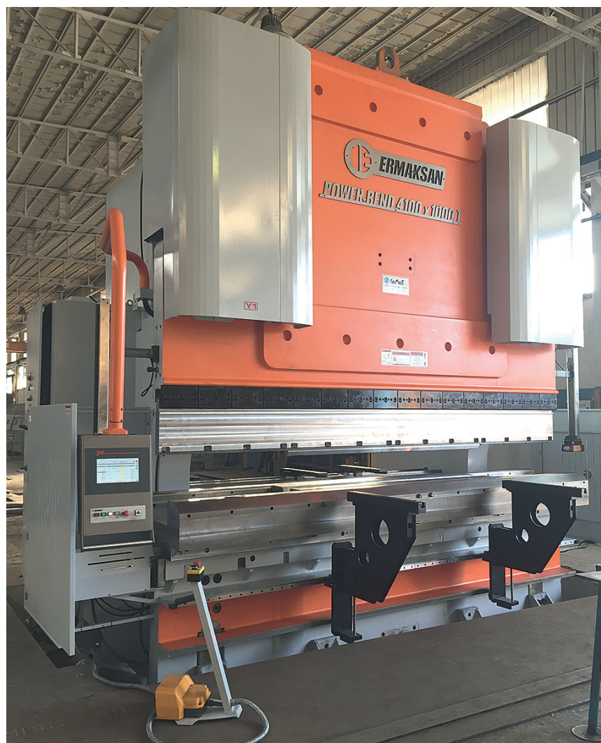
Vista frontale pressa piegatrice Ermaksan Power-Bend Pro 4100 x 1000 t fornita e installata presso l'unità produttiva di Abraservice da Co.Ma.F.
