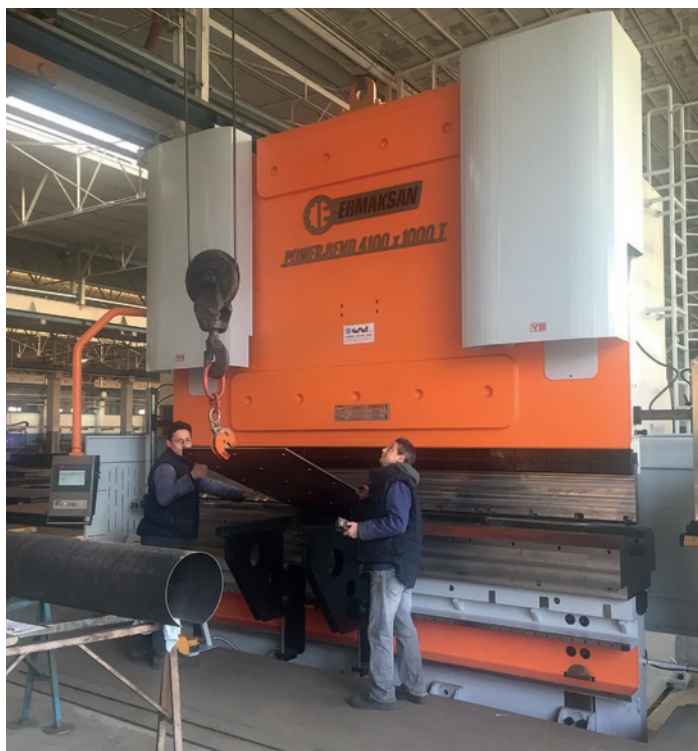
Fase di lavorazione lamiera in Abraservice sulla nuova pressa piegatrice Ermaksan fornita e installata da Co.Ma.F.
