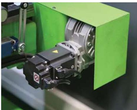
■ Gli assi del motore dotati di servomotore AC e possono muoversi con precisione e velocemente grazie a viti a ricircolo di sfere, riduttori e guide (S)
