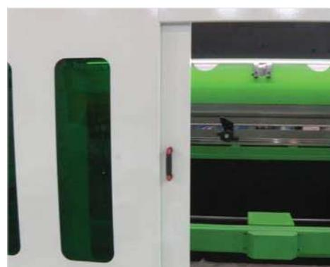
■ Massima sicurezza con carter laterali e posteriori dotati di switch. Finestre sul retro permettono di guardare all'interno della macchina (S)
