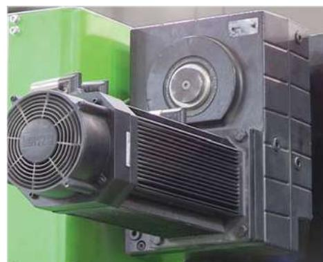
■ Movimento del portalamina con servomotori AC sincroni ad alta efficienza (S)
