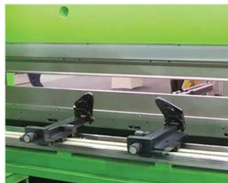
■ Registro a servomotori a 4 assi (X, R, Z1, Z2) con accuratezza di posizionamento 0.05mm (S)
