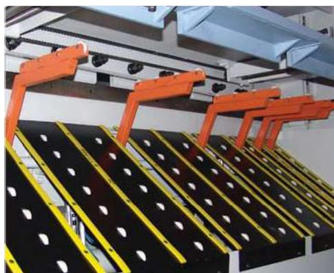
■ La lamiera tagliata può scivolare senza rovinarsi grazie ai rulli e alle sfere sul modello di sostegno pneumatico "a leve" (O)
