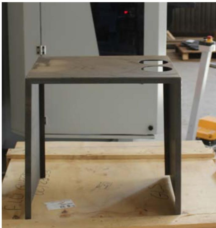
**Dettaglio coperchio piegato spessore 2 mm, cassa per pompa**
