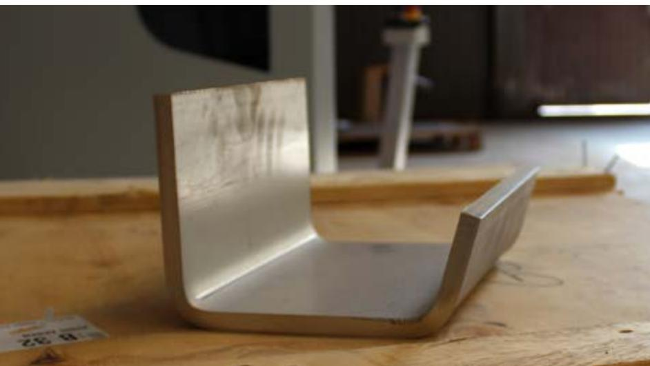
Particolare piegato in acciaio inox, spessore 15 mm per applicazione settore oil&gas
