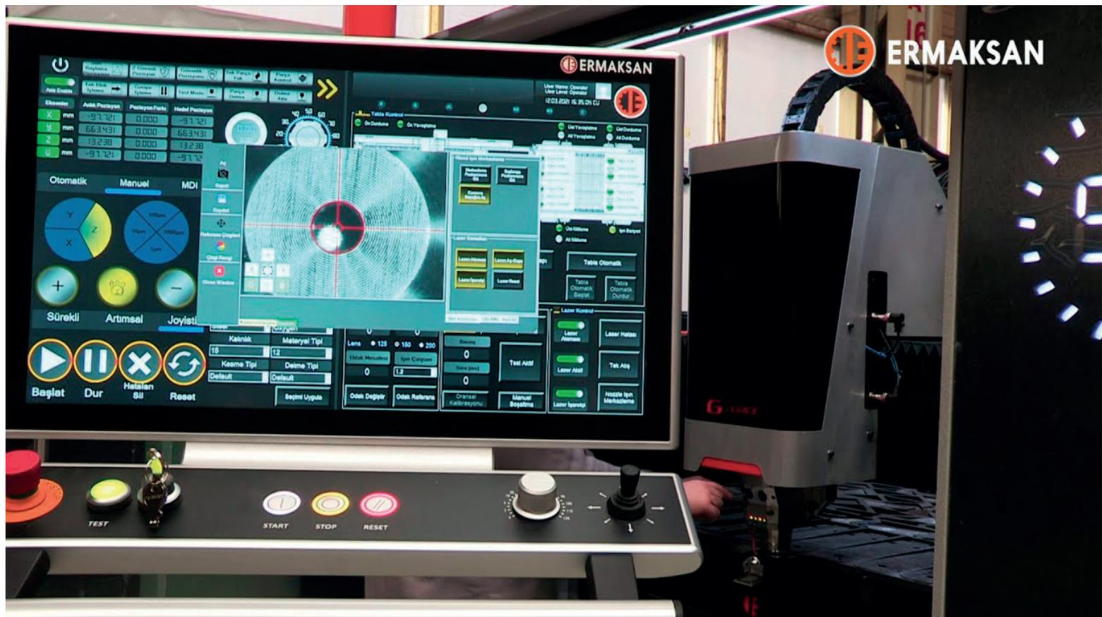
Il dispositivo Calbec per il centraggio degli ugelli.
