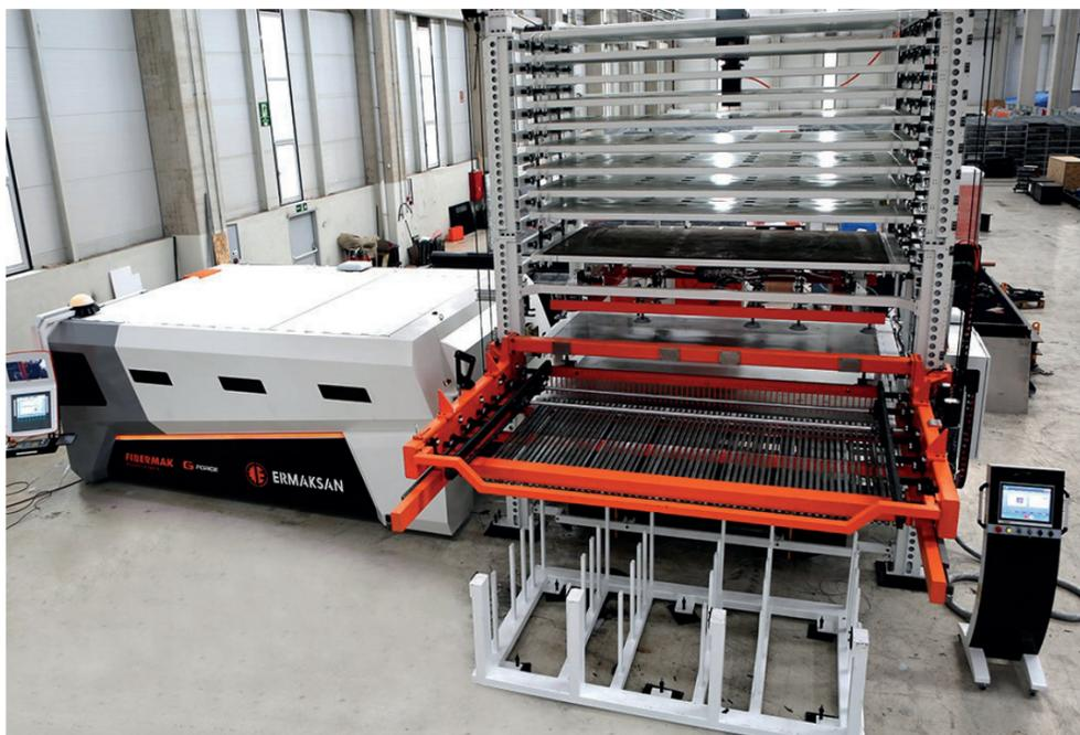
Un impianto taglio laser Ermaksan Fibermak con sistema di carico/scarico a 10 pallet.
