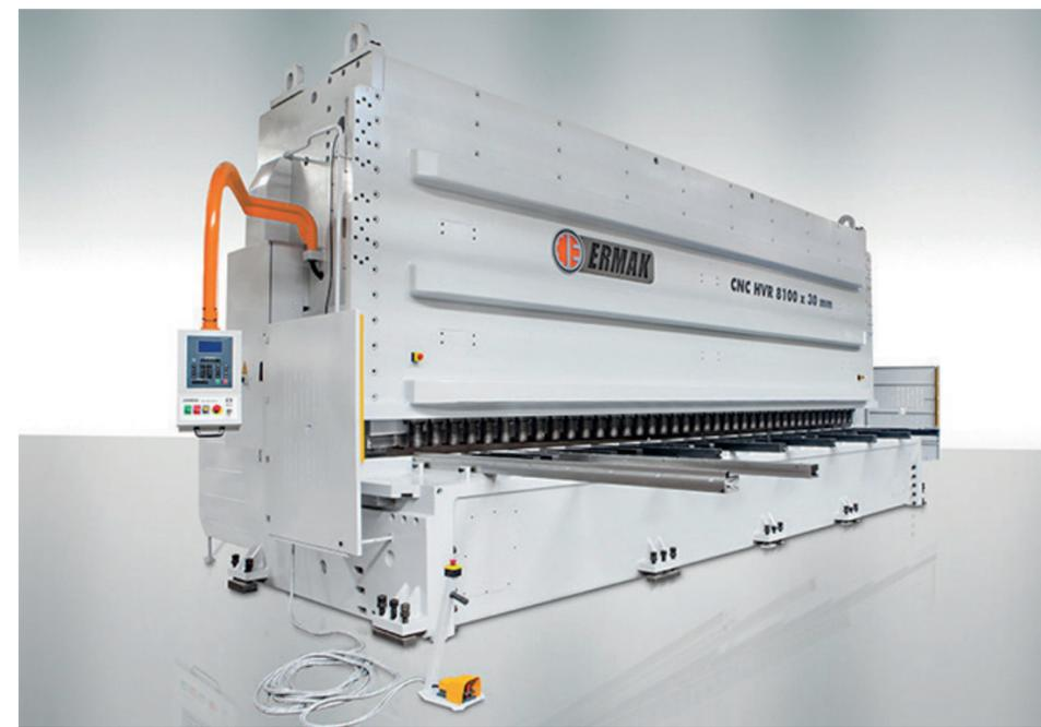
Una cesoia idraulica mod. HVR ad angolo variabile 8000x30mm.
