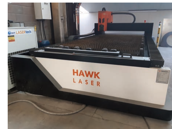
La macchina di taglio laser in fibra modello Fibermak Hawk installata presso Ventilazione Mapelli
