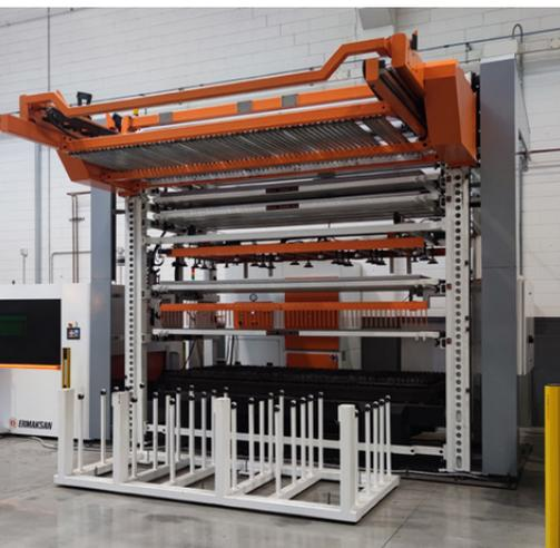
Flessibilità, libertà e rapidità operativa sono assicurate in Acquasystem anche dalla presenza del sistema di carico/scarico automatico Fibermak Towermak
