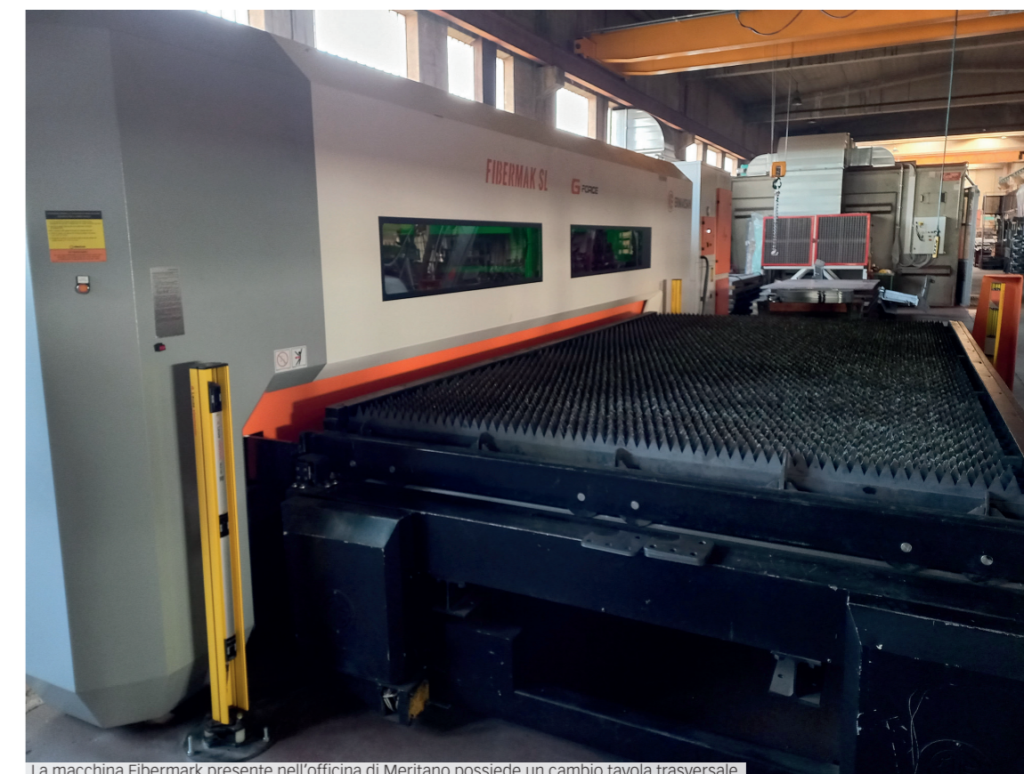
La macchina Fibermark presente nell'officina di Meritano possiede un cambio tavola trasversale.
