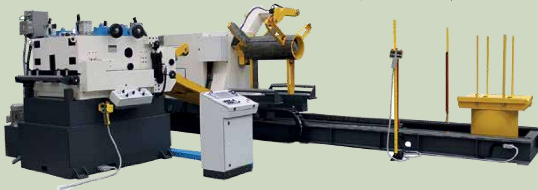
Linea di alimentazione compatta per nastro Tecnocoil con larghezza max 1.000 mm, spessore max 6 mm, peso del coil max 10 t
