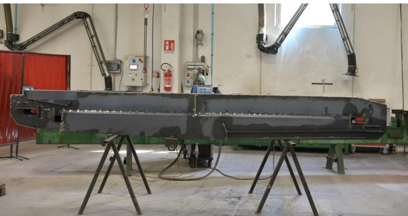
Componente per modello Nastro Trasportatore 4M di Facma; carcassa di un nastro trasportatore inclinato a facchini composto all'80% in lamiera da 1,5 e 2 mm di spessore, mentre il restante in lamierati dai 4 agli 8 mm
