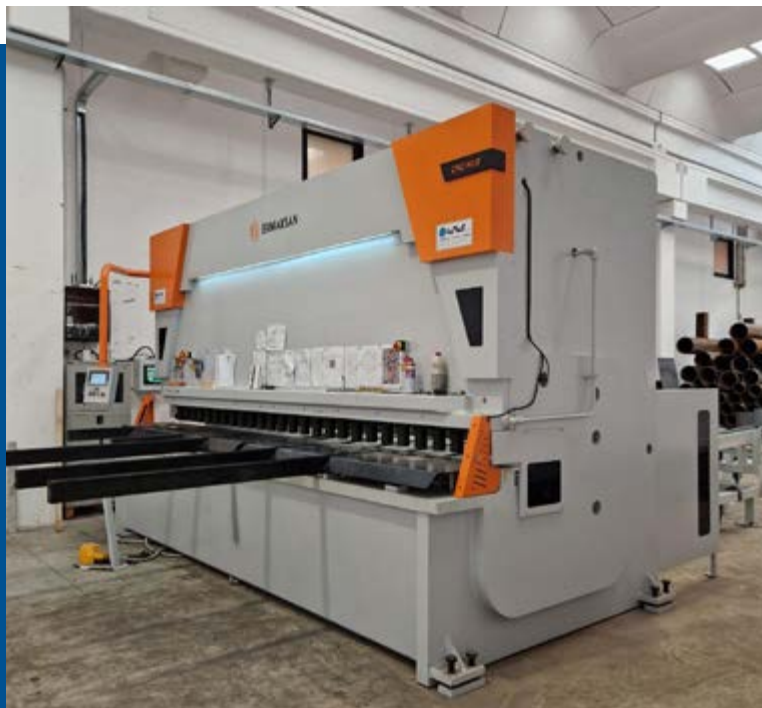
Fornita a Paparelli da Co.Ma.F. la cesoia ad angolo variabile a Cnc Ermaksan HVR 4100-25 assicura una lunghezza utile di taglio fino a 4.100 mm, e capacità di lavorare spessori fino a 25 mm
