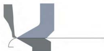
Downwards Radius Bending Piega raggiata verso il basso
