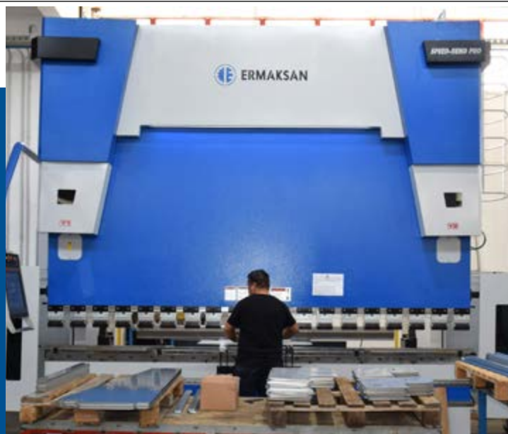
La nuova pressa piegatrice sincronizzata Ermaksan Speed-Bend 4100x320 ton a 7 assi controllati, completa di tavola di centinatura, consente a MED di sfruttarne la precisione su 4.000 mm di lunghezza di piega, con apertura fino a 900 mm
