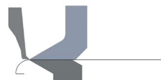
Piega radiale verso il basso DownwardsRadiusBending
