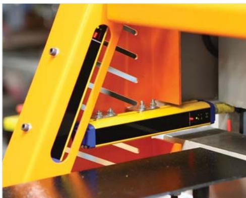
■ Sistema di protezione mani illuminato ad altissimo grado di sicurezza permettendo operazioni veloci (O)
