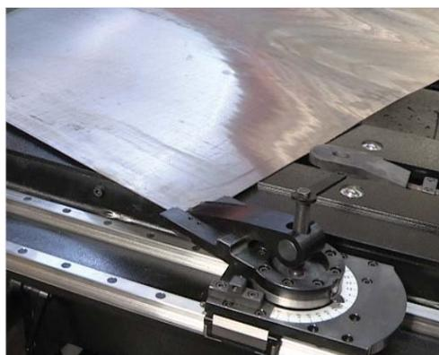
■ Il sistema di caricamento frontale della lamiera permette il taglio angolare della lamiera (O)
