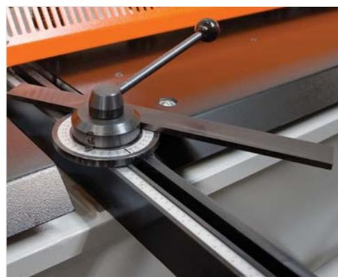
■ Alta precisione, facilità di tagli angolari grazie alla regolazione dell'angolo tramite goniometro (O)
