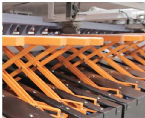
■ Il sistema di supporto "X" opera in modo parallelo al terreno per sostenere la lamiera durante il taglio (O)
