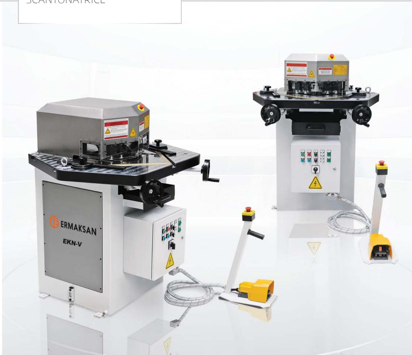
▶ Scantonatrice idraulica
