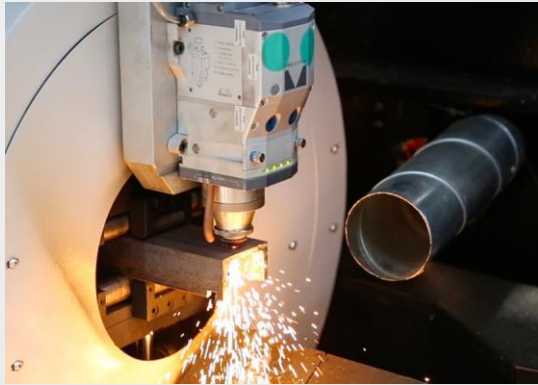
L'opzione di taglio di tubi e profili consente di tagliare tubi, file quadrati, rettangolari, a "U" e a "L".
