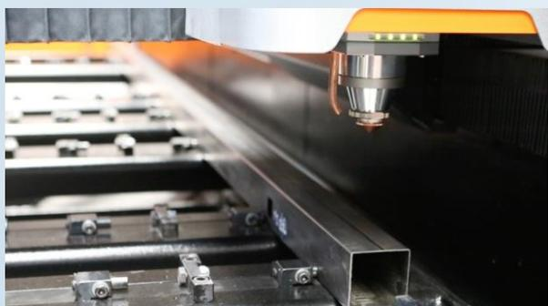
È stato sviluppato un sistema di allineamento automatico dei profili per un taglio preciso dei profili con un tavolo di taglio pro- file nelle macchine con opzioni di taglio di tubi e profili Fibermak. Questa funzione evita le derive di misura che possono verificarsi nei tagli dei profili.
