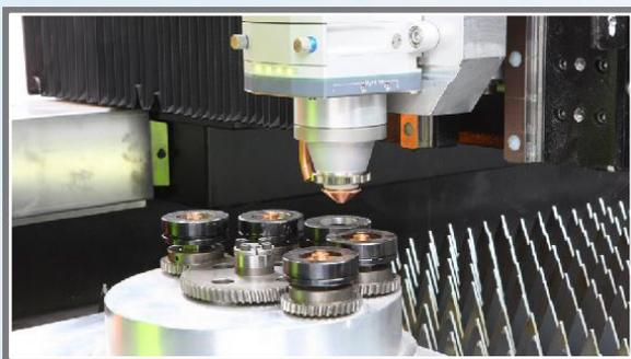
Per tagliare materiali di diverso tipo e spessore è necessario utilizzare diversi tipi di ugelli con diametri differenti. In base allo spessore e al tipo di lamiera selezionati, il sistema seleziona e cambia automaticamente l'ugello definito.
