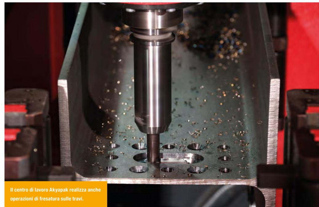
Il centro di lavoro Akyapak realizza anche operazioni di fresatura sulle travi.
