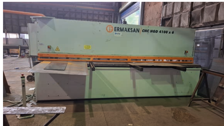
La cesoia a ghigliottina Ermaksan CNC HGD da 4.100 mm di lunghezza per 6 mm di spessore installata in Keller
