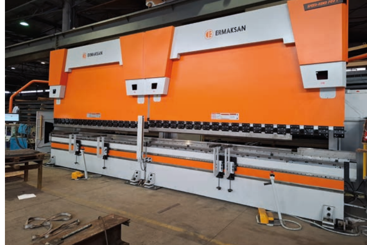
L'impianto Ermaksan si compone di due presse piegatrici idrauliche sincronizzate della serie Sped-Bend a 7 assi ciascuna con 4.100 mm di lunghezza di piega e 400 tonnellate di potenza
