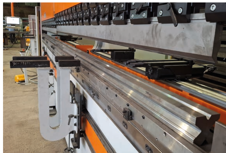
Entrambe le piegatrici Ermaksan sono dotate di tavola di centinatura WILA
