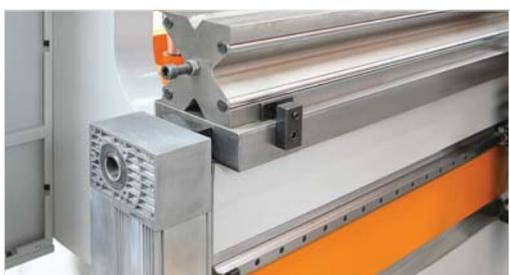
■ Il sistema di tavola di centinatura motorizzata comunica con il CNC per la sua regolazione automatica, così da assicurare piega costante e uguale angolo in tutti i punti (S).
