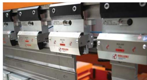
■ Sistema di bloccaggio utensili pneumatico automatico con sgancio frontale (O)
