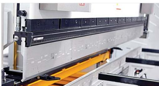
■ Sistema bloccaggio utensili Wila idraulico (O)
