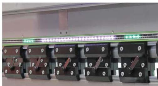
■ Con la barra colorata a LED, viene indicata la posizione dove deve essere posizionata la lamiera per la piega e/o la stazione di piega (O)
