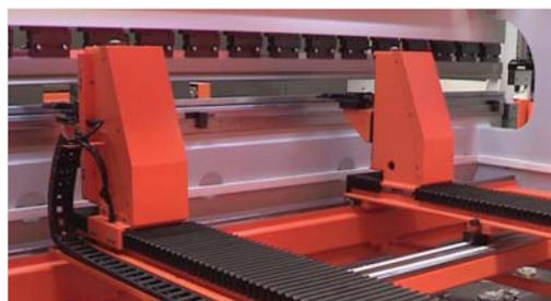
■ Veloce e preciso, il registro con servo motore a 6 assi (X1+X2+R1+R2+Z1+Z2) Permette di incrementare l'efficienza di produzione e la qualità (O)
