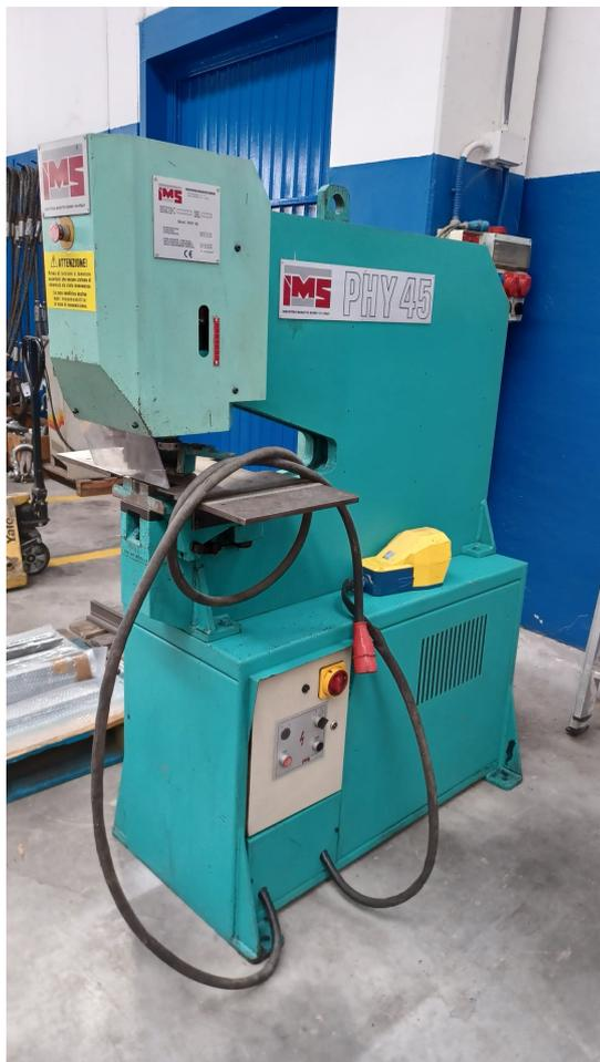
PUNZONATRICE IDRAULICA "IMS" USATA, MOD. PHY45 , PUNZONATURA DIAM. 27X13, COMPLETA DI ATTREZZATURA SPECIALE PER FORI FINO DIAM. 100X3 (R=42KGS/MM2), ANNO DI PRODUZIONE 1996, NUMERO DI SERIE 1299, CERTIFICATA CE
